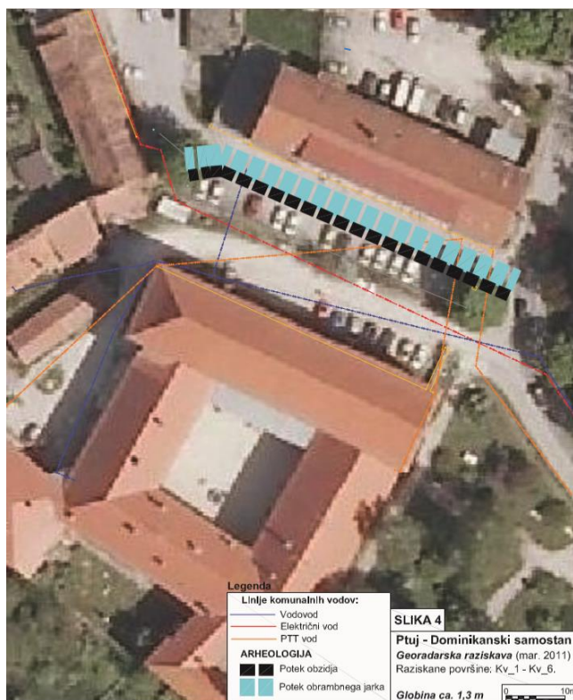
Slika 3: Potek mestnega obzidja (črna črtkana linija), ugotovljen z geofizikalno raziskavo
